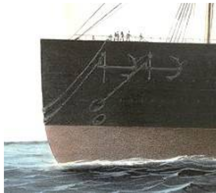
Détail des ancrs du Great Eastern On reconnaît les ancrs articulées du modèle Trotman
