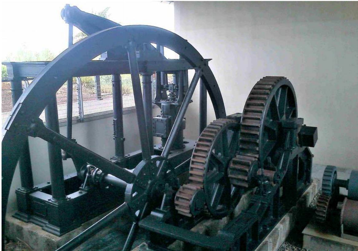
Machine de Watt à l'usine-musée Stella Matutina. On distingue le grand volant d'inertie et le piston moteur en arrière plan mais surtout le balancier. (photo AF)
